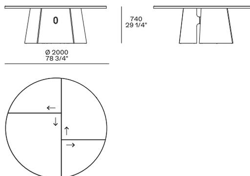
Le frecce indicano l'orientamento delle venature del legno.
